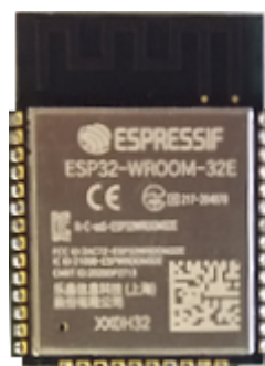
Fig. 3: Ausgewähltes Modul ESP32-WROOM-32E
