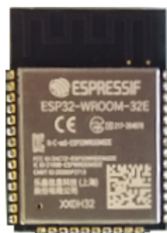
Fig. 3: Ausgewähltes Modul ESP32-WROOM-32E
