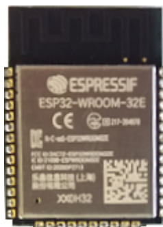
Fig. 3: Ausgewähltes Modul ESP32-WROOM-32E
