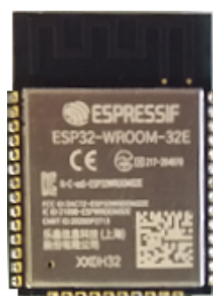
Fig. 3: Ausgewähltes Modul ESP32-WROOM-32E
