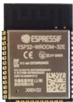
Fig. 3: Ausgewähltes Modul ESP32-WROOM-32E
