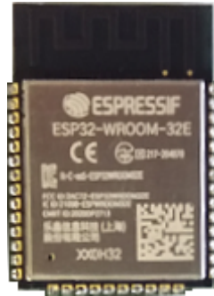
Fig. 3: Ausgewähltes Modul ESP32-WROOM-32E
