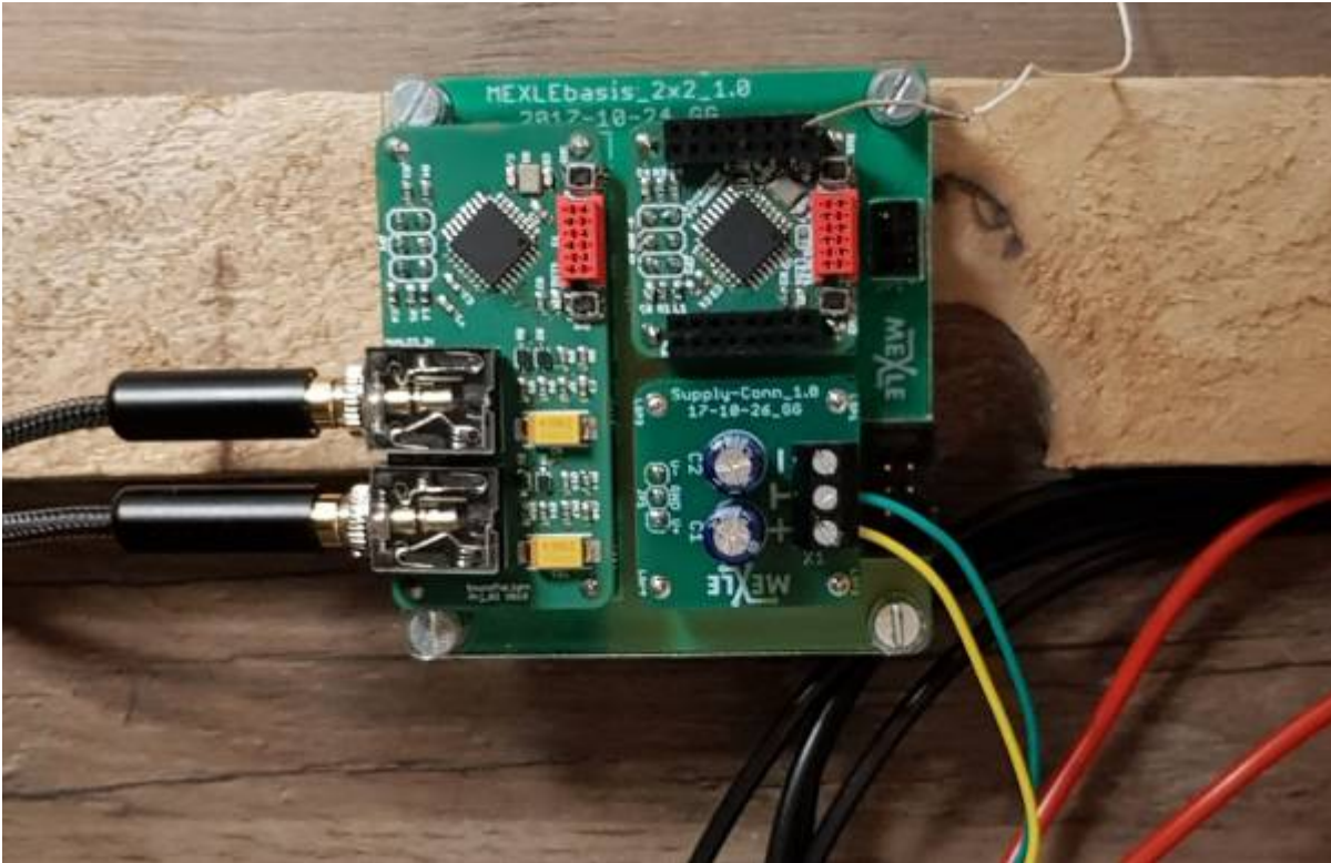
Elektronik des LED cube auf MEXLE2020 Basis (zwei ATmega328 zur Auswertung von Musiksignalen mit Eingangsfilter und FFT, sowie zur Ansteuerung des Würfels)
